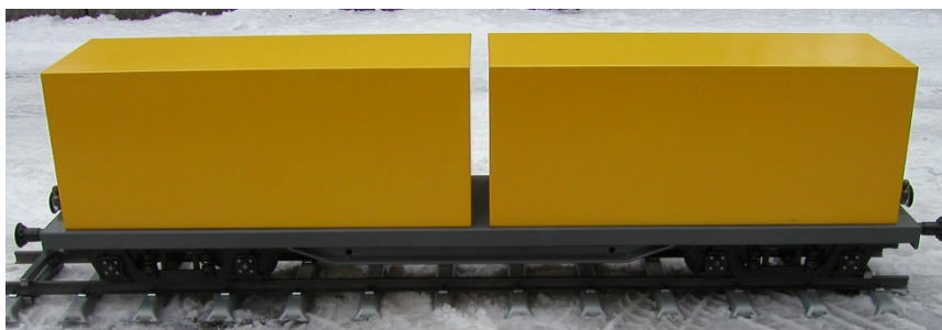
Containerwagen, mit Schwanenhalsdrehgestell, gefedert, für Personentransport, Gewicht ca. 50 Kg, LÜP: 1554 mm, Art.Nr. 8600030
