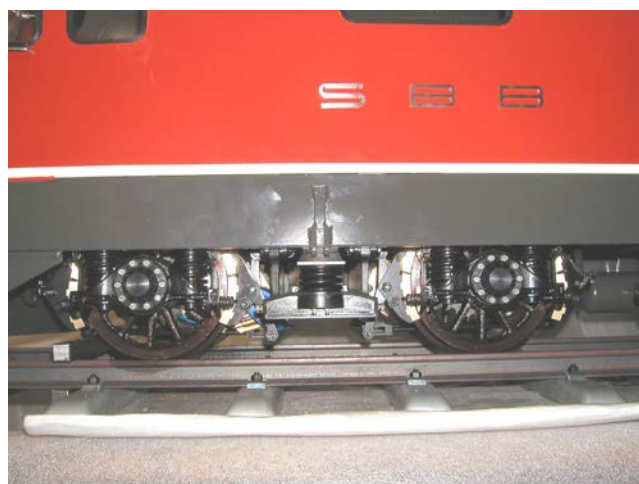
Detail Drehgestell, Kastenabstützung, Bremsen
